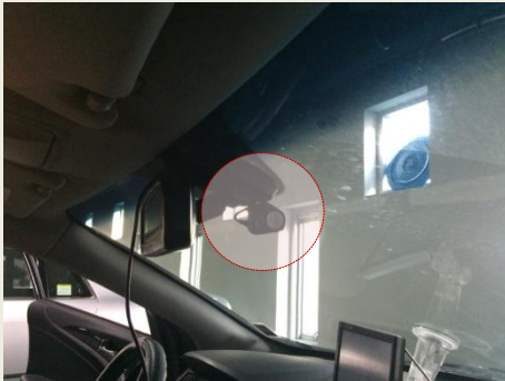
CAM1 카메라에 케이블 연결한 뒤 유리면 부착
