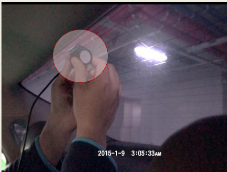
CAM2 카메라에 케이블 연결한 뒤 유리면 부착
